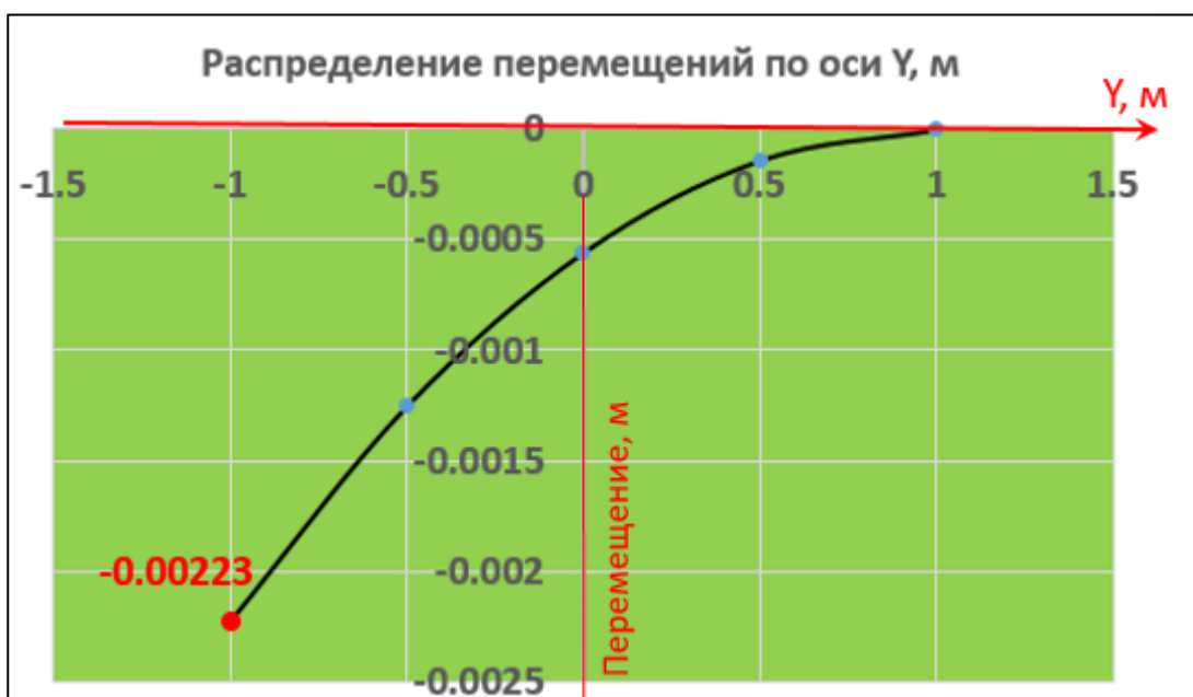
Рис.4.23 График распределение перемещений вдоль оси Y (квадратичная зависимость от расстояния по оси Y от закрепленной грани). Плоскость куба с координатой Y = 1 м закреплена по условию задачи. Поэтому перемещение имеет знак «минус».
